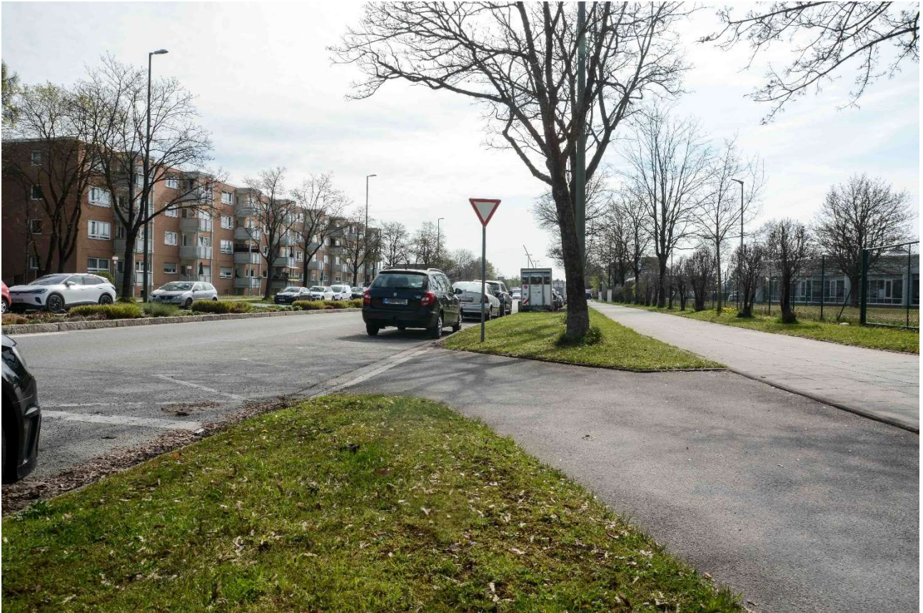
Abbildung 1: Am Otto-Hahn-Ring: Der rechts von einem Radweg kommende Radverkehr wird hier direkt auf die Straße geleitet. Durch einen farblich markierten Übergangsbereich könnte die Situation erheblich verbessert werden. (Quelle: Fraktion Die Grünen – Rosa Liste)
