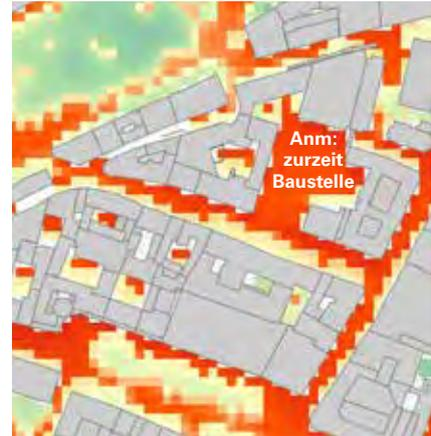
Abb. 100: PET-Index, 14 Uhr, 1,10 Meter Höhe
