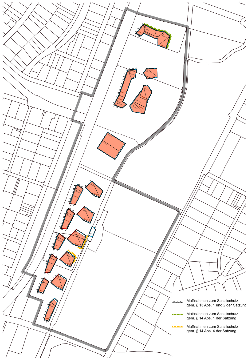
Abb. 1: Schallschutzmaßnahmen – ohne Maßstab, Quelle: © bgsm Architekten Stadtplaner
