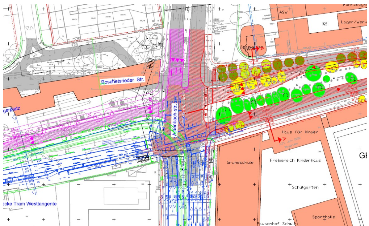
Abbildung 1.1: Darstellung der Fahrbahnverschwenkung im Kreuzungsbereich der Boschetsrieder Straße mit der Aidenbachstraße (aktuelle Straßenplanung als Vorplanung als planerische Grundlage im Rahmen des Bebauungsplanes Nr. 1769a – siehe auch größerer Umgriff in Anlage 1 (Quelle: Ing.- Büro Krombach)
