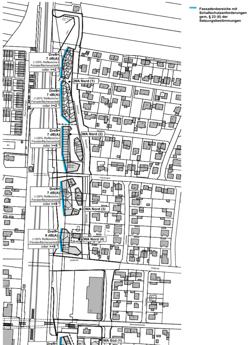
Abb.4a: Fassadenbereiche mit Schallschutzanforderungen zur Vermeidung von Schallreflexionen nördlich der Düflerstraße zu § 23 Absatz 6 der Satzung © DRAGOMIR STADTPLANUNG GmbH auf Basis des Schallgutachtens von Möhler + Partner Ingenieure AG/LHM
