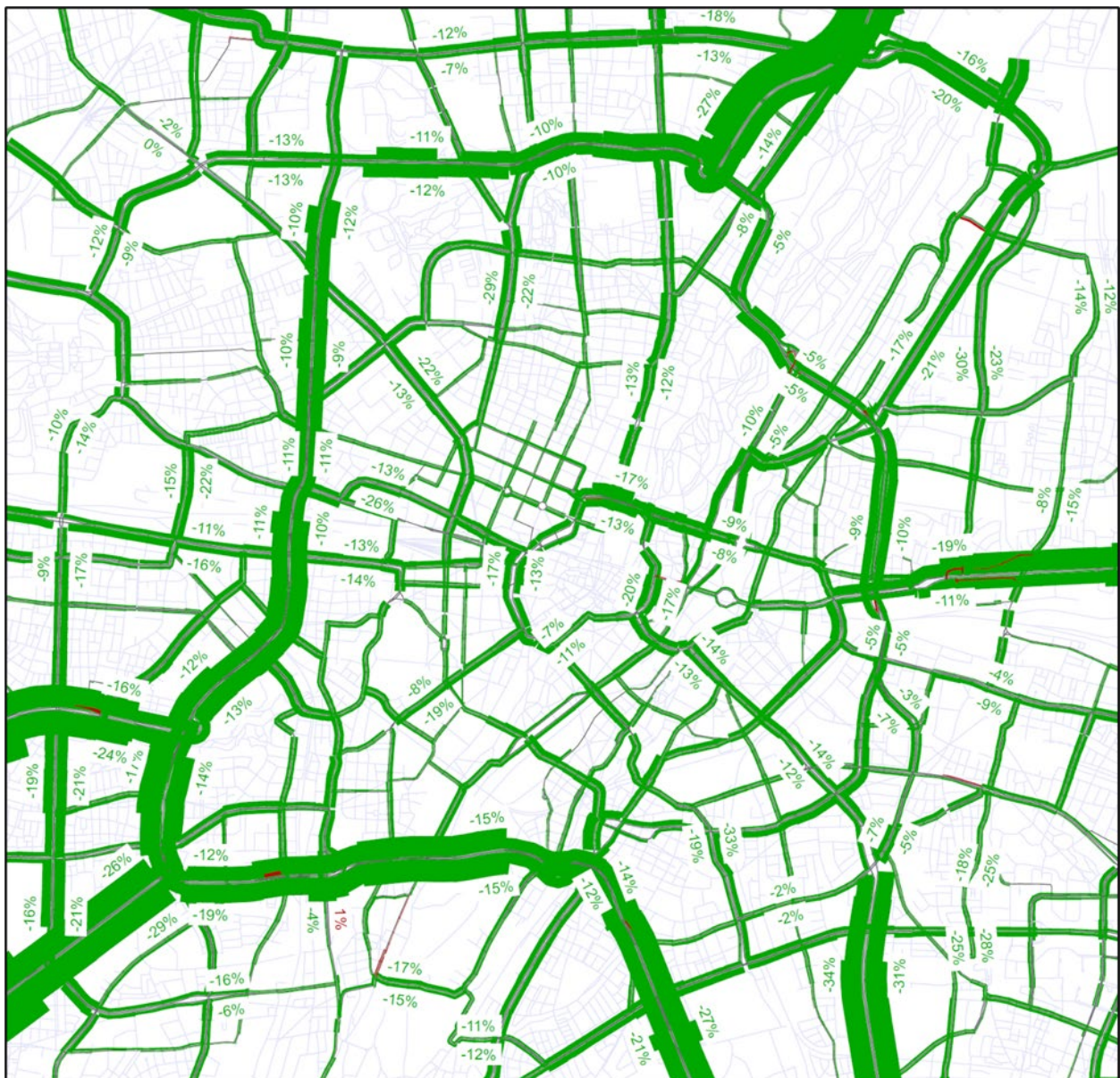
Differenzenplot der Verkehrsbelastung zwischen Szenario 2e-I_Bus und der Basisbelastung aus der Verkehrsmengenkarte 2020 in Prozent (Belastungszunahmen rot, Belastungsabnahmen grün)
