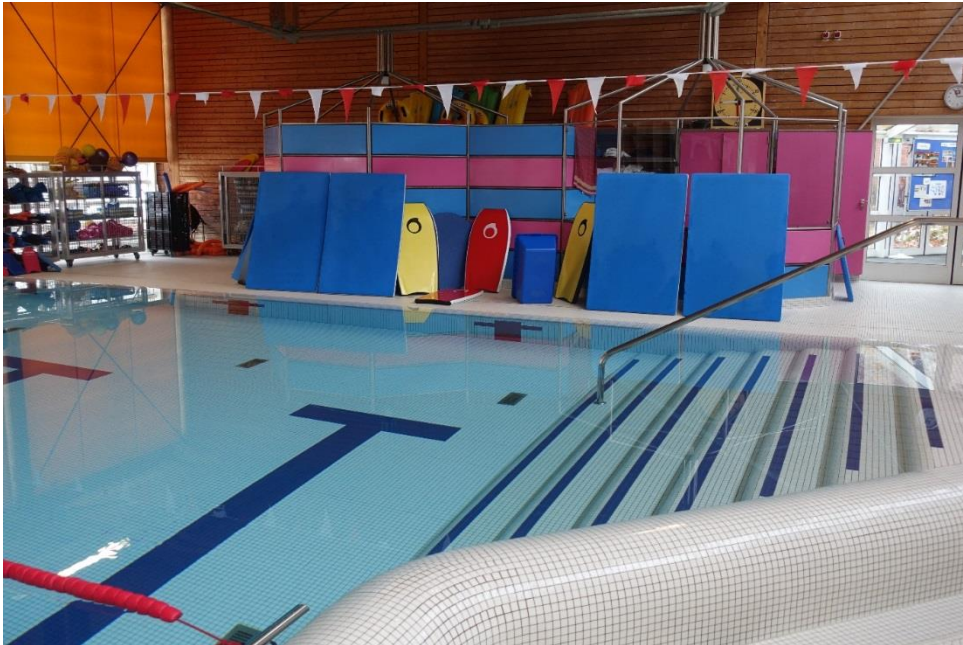
Beispiel: Markierung des Beckenendes mit Fähnchen, Schwimmbecken der Realschule für Sehbehinderte und Blinde in Unterschleißheim
