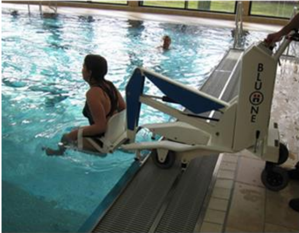
Beispiel: Lifter als Einstiegshilfe im Hallenbad Giesing, München (Foto: Birgit Schimmel)
